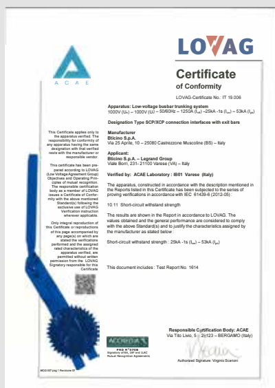
Certificato di conformità per il collegamento tra trasformatore e condotto sbarre (montato sul box del trasformatore in resina)
