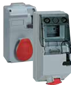
PRESE INTERBLOCCATE Con o senza guida DIN35 16/32A IP44 e 63A IP66 da completare con scatola o centralino
