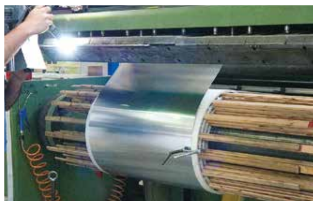
Saldatura TIG in atmosfera controllata per gli attacchi BT.
