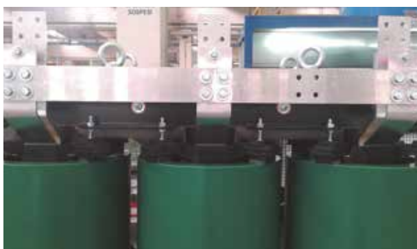
Esempio di terminali BT
