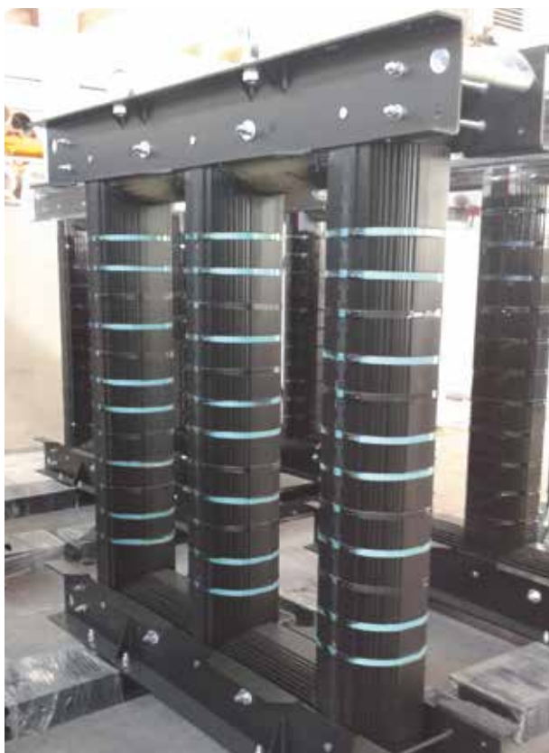
Esempio di nucleo magnetico
